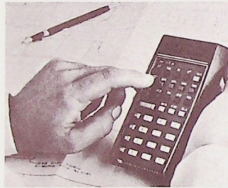
Bild 1. Elektronischer Taschenrechner „HP-35“ von Hewlett-Packard zur Verarbeitung von Zahlen zwischen 10^{-99} und 9,999999999 \cdot 10^{99}
