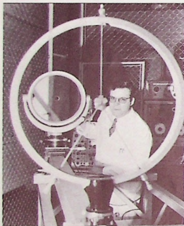
Empfangeinrichtung der 5,4 km langen Versuchsstrecke für die Nachrichtenübertragung mit Laserstrahlen. Die Kopfstationen bestehen aus Cassegrain-Teleskopen mit einem konvexen Okularspiegel (im Vordergrund) und einem konkaven Objektivspiegel, hinter dem ein Lasersender beziehungsweise ein Detektor zur Auswertung des ankommenden Laserlichts angeordnet ist
